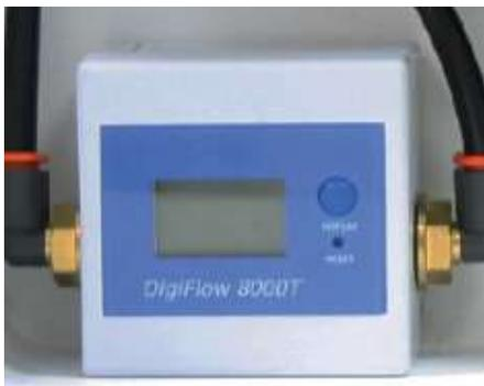
L'impianto è dotato di un controllo volumetrico per i litri d'acqua erogati.
