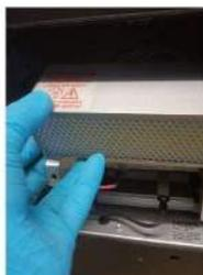
**Far scorrere la parte da installare nell'unità verso l'alto come da figura. Assicurarsi che il lembo posteriore si agganci alle due scanalature sul retro della piastra e che le staffe e i perni siano correttamente allineati**
