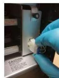
**Inserire il connettore e premere saldamente finchè le due linguette si bloccano.**
